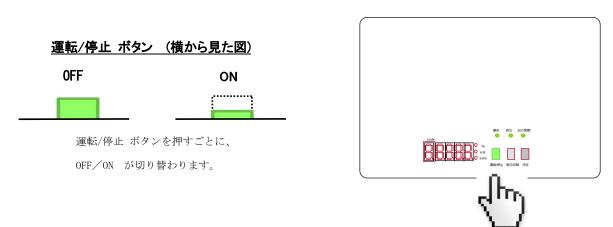
2 運転が始まり、表示部に太陽光の発電電力が表示され、連系 LED が点灯します。
