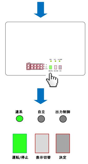
3 製品が運転を開始します。 連係 LED ランプが緑色(自立 LED ランプ、 出力制御 LED ランプは消灯)に変わって いることを確認します。
